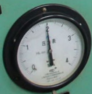
第20级后蒸汽压力
